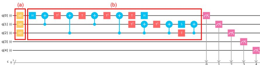
Figura 6.10: Circuito Quantum Half-Adder implementado na plataforma IBM Quantum Experience. (a) Preparação do estado inicial (substituir Id por  $X$  para preparar estados  $|1\rangle$ ). (b) Circuito adaptado. Mapeamento de qubits:  $q[0] = |c\rangle$  (ancilla),  $q[1] = |b\rangle$  e  $q[2] = |a\rangle$ .
