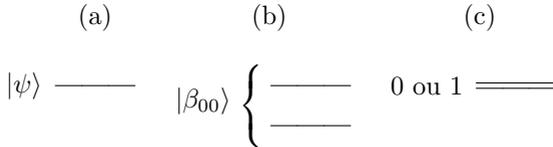
Figura 3.5: (a) Linhas horizontais simples representam 1 qubit. (b) Representação de 2 qubits com o rótulo representando o estado de Bell  $|\beta_{00}\rangle = \frac{1}{\sqrt{2}}(|00\rangle + |11\rangle)$ ; a notação com chave é útil para representar entradas compostas por estados emaranhados. (c) Linhas horizontais duplas representam 1 bit clássico, ou um cbit.
