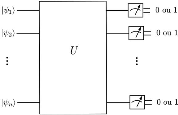
Figura 3.1: Esquema geral de um computador quântico no modelo de circuitos. Os qubits são preparados em estados iniciais e são submetidos a operações unitárias simbolizadas pela caixa de rótulo  $U$ . Após a sequência de operações, os qubits são lidos (ocorre a medição dos qubits na base computacional), fornecendo uma sequência de bits clássicos com o resultado da computação. Fonte: [14], p. 24.
