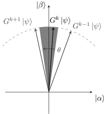
Figura 4.27: Projeção do estado final  $G^k |\psi\rangle$  na direção do estado desejado  $|\beta\rangle = |x_0\rangle$ . Aplicar o operador  $G$  mais uma vez faz com que a projeção na direção desejada fique menor. O mesmo vale se o operador  $G$  for aplicado por menos de  $k$  vezes.
