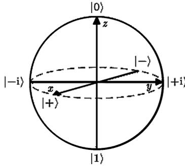
Figura 3.3: Pontos destacados na esfera de Bloch.
